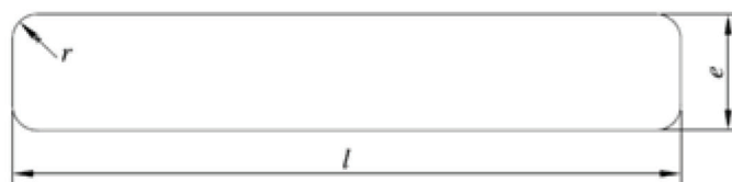
Perfil C: barra chata de aço-mola com bordas retas e cantos arredondados
