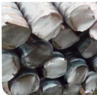
Processo de corte por cisalhamento, barras sujeitas a amassamentos pontuais.
