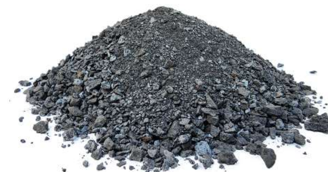
Agregado Siderúrgico - Pó de Pedra (0 a 4,75 mm)
