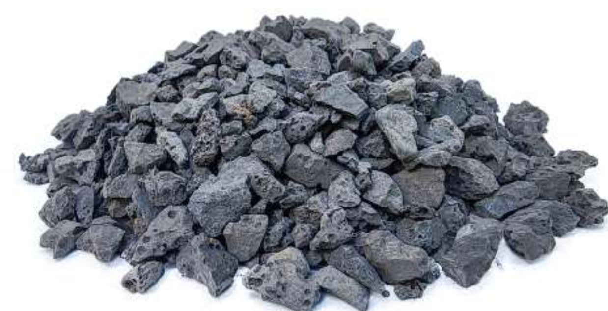
Agregado Siderúrgico - Pedrisco (4,75 a 9,51 mm)
